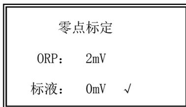
ORP 后面的数值为当前测量数据，标液后面的数值为标准液实际的 ORP 值。当选择的标准液正确时，屏幕右下角会显示“✓”，表明可以标定，按 ENTER 键测量数据会稳定显示 0mV 表明仪表零点标定完成。当选择的标准液不合适时，会显示“×”，表明有误不能标定，ENTER 键被屏蔽。此自动识别标准液的功能可以有效防止误操作，标定不准确。
