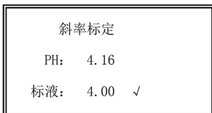
将 PH 电极从标准液 pH6.86 中取出,清洗干净并用滤纸吸干,然后将电极放入标准液 pH4.00(仪表自动识别标准液,若标准液是碱性则显示 9.18)中,轻轻搅拌几下,等仪器显示数值稳定。屏幕右下角会显示“√”,表明可以标定,按 ENTER 键测量数据会稳定显示 4.00(或 9.18)表明仪表斜率标定完成。按 MENU 键,进入模式设置菜单三。
