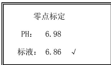
PH 后面的数值为当前测量数据,标液后面的数值为标准液实际的 PH 值。当选择的标准液正确时,屏幕右下角会显示“√”,表明可以标定,按 ENTER 键测量数据会稳定显示 6.86 表明仪表零点标定完成。当选择的标准液不合适时,会显示“×”,表明有误不能标定,ENTER 键被屏蔽。此自动识别标准液的功能可以有效防止误操作,标定不准确。当标准液无误,又无法标定时,按 ENTER 键+UP 键强制标定,其他相同。
