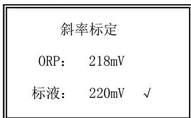
将 ORP 电极清洗干净并用滤纸吸干，然后将电极放入标准液（220mV）中，轻轻搅拌几下，等仪器显示数值稳定。屏幕右下角会显示“✓”，表明可以标定，按 ENTER 键测量数据会稳定显示 220mV 表明仪表斜率标定完成。按 MENU 键，进入模式设置菜单三。
